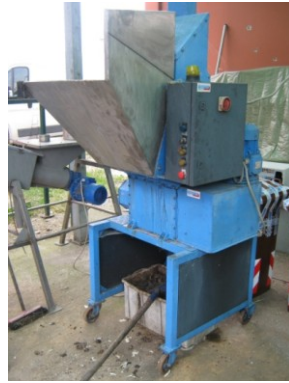
Figura 21: mulino a coltelli utilizzato nella sperimentazione
