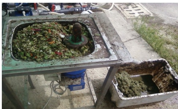
Figura 25: Dissipatore sottolavello utilizzato durante la sperimentazione
