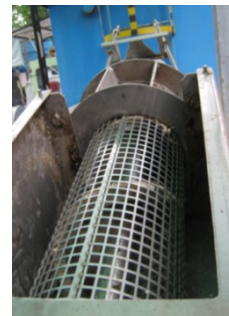
Figura 22: pressa – coclea utilizzata nella sperimentazione.
