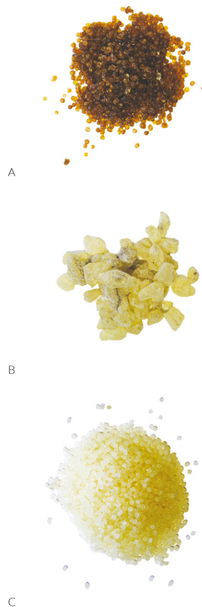
05. Alcuni campioni delle matrici testate per la realizzazione del materiale composito: colla naturale (A), resina naturale (B), acido polilattico PLA (C).
