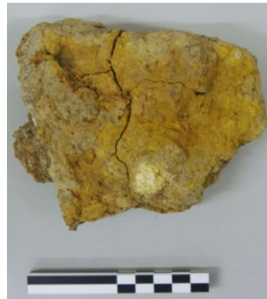
fig. 47 – Scoria a calotta, US 11195, Periodo 4, 6,6×6,6×3,9 cm, 298 gr.
