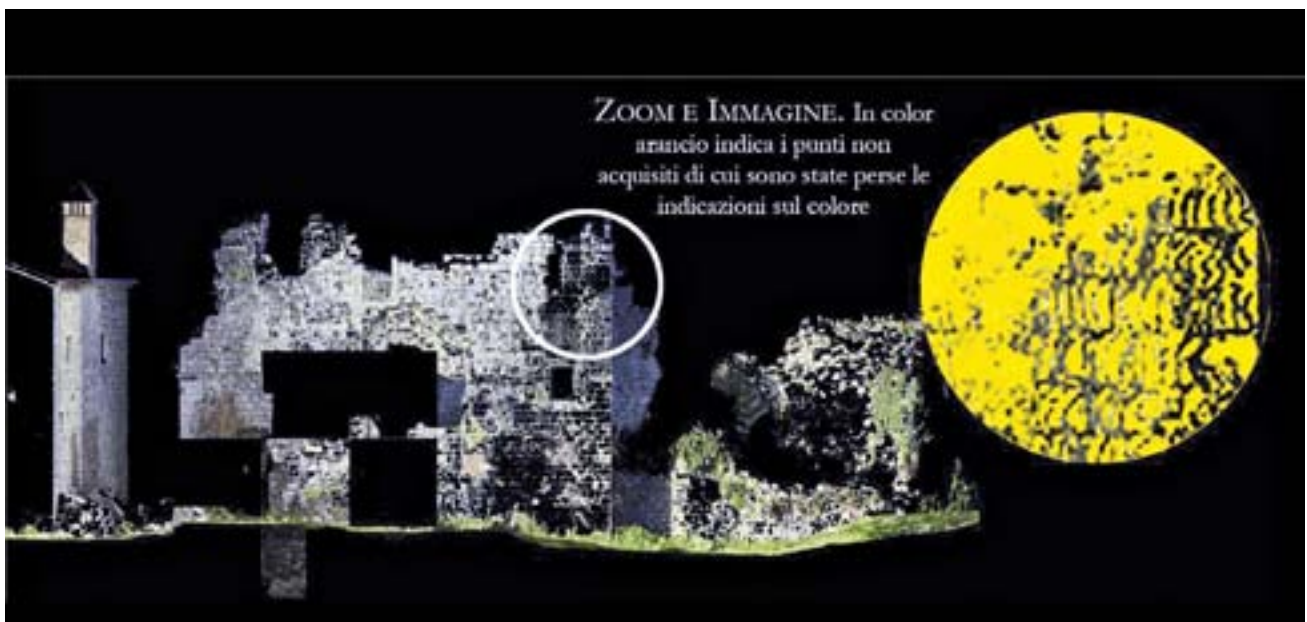
fig. 5.17 – Proiezione ortografica: non è possibile riproiettare l'immagine sui punti non acquisiti, quindi non tutti sono colorati, ma a molti pixel è stato assegnato il colore dello sfondo (nero in questo caso).
