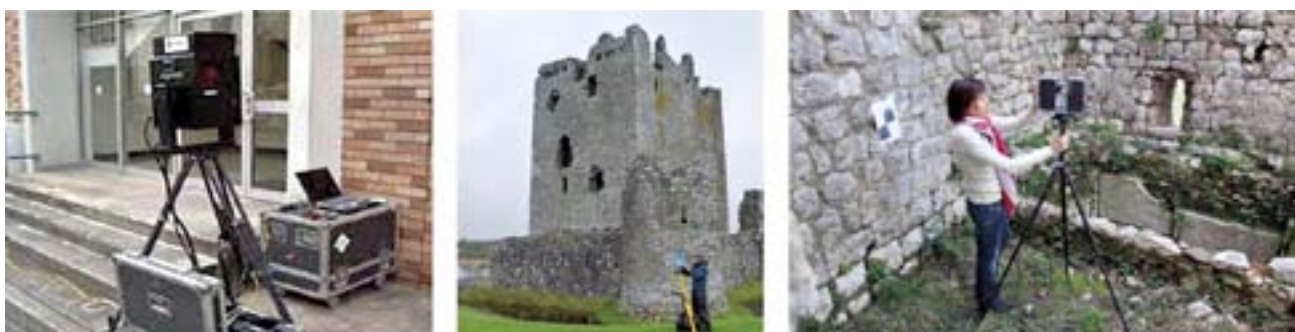
fig. 5.11 – Strumenti pesanti e strumenti leggeri: a) il Cirax, tra i primi laser scanner a tempo di volo b) lo Z&F Imager5000, ancora commercializzato, con batteria e unità di controllo esterna c) il FARO Focus3D, il più piccolo e leggero oggi sul mercato, strumento utilizzato in questo lavoro.
