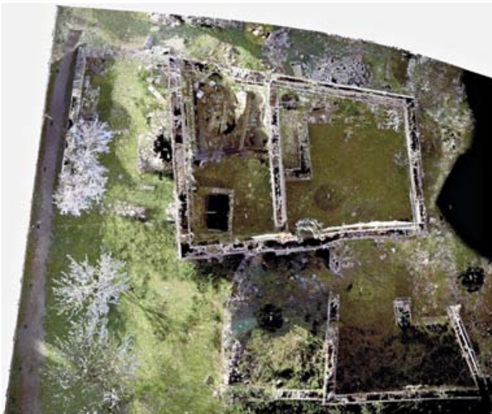
fig. 5.14 – Planimetria del c.d. "Palazzo del Doge": sovrapposizione delle immagini fotografiche alla nuvola di punti.
