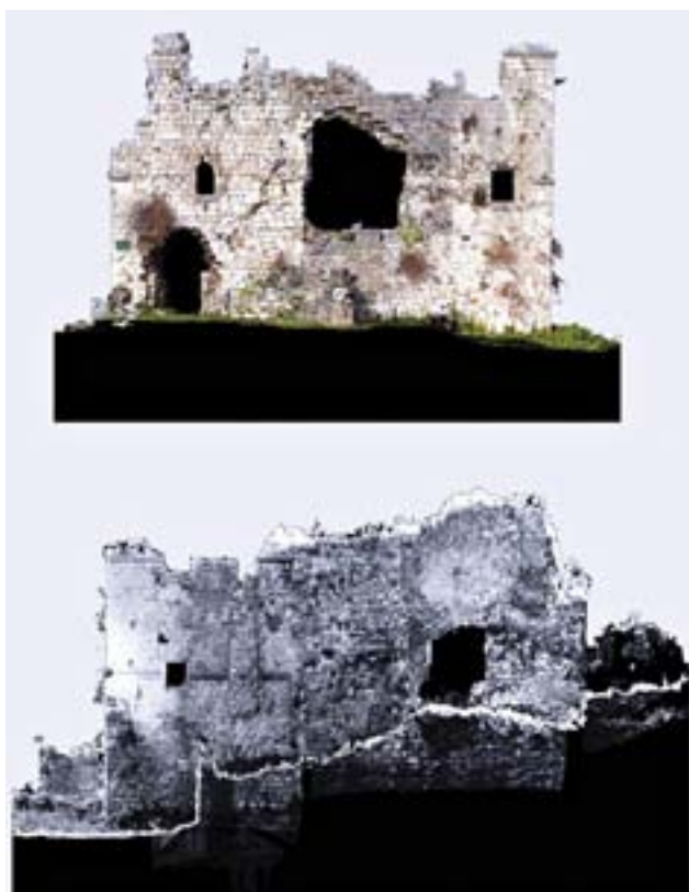
fig. 5.15 – Produzione delle proiezioni ortografiche: prospetto principale con la sovrapposizione delle immagini fotografiche e prospetto laterale in scala valore di riflettanza.
