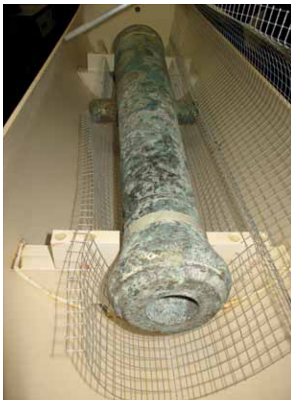
Fig. 10. Operazione di restauro per mezzo di elettrolisi della petriera in bronzo, ad opera di G. Moretti nei laboratori dell'Università Ca' Foscari (foto G. Moretti).
