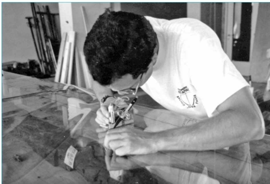
Fase di rilievo, in scala 1:1, con puntatore laser, degli elementi dello scafo.
