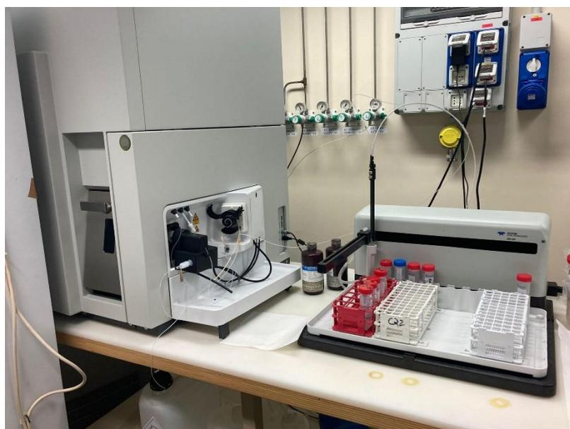
*Figura 26: ICP-MS con autocampionatore impiegato per la determinazione degli elementi in traccia e delle terre rare.*
