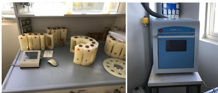
*Figura 27: Recipienti cilindrici in PTFE (a sinistra) e microonde Ethos 1 (a destra) impiegati per la digestione acida dei campioni.*
