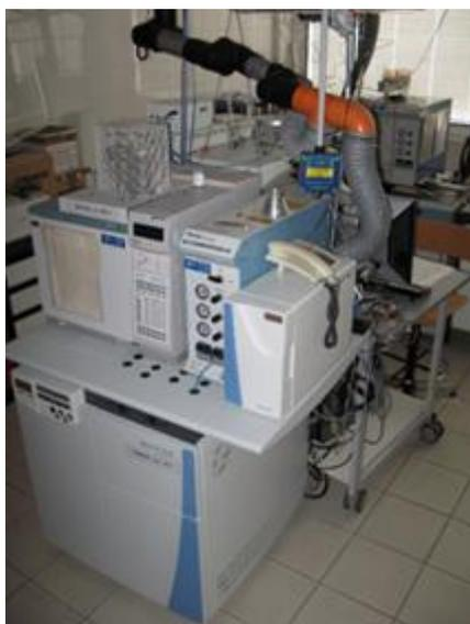
*Figura 23: TC/EA-IRMS utilizzato nelle analisi dei rapporti isotopici di idrogeno e ossigeno.*
