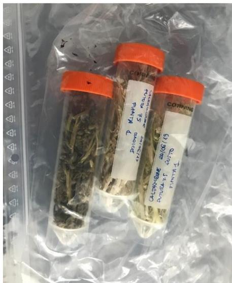
*Figura 17: Esempio di campioni di infiorescenza liofilizzata e inserita in boccette Falcon® da 50ml.*
