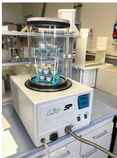
*Figura 16: Foto del liofilizzatore impiegato.*
