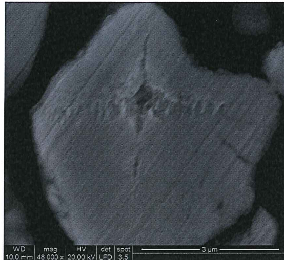
Fig. 1.17: Immagine FEG-ESEM di un grano di Cinabro del campione Hg-P dopo le acquisizioni EBSD.
