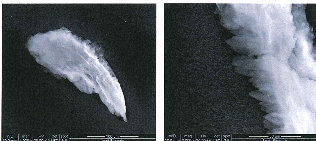
Fig. 1.14. Immagini SEM di cristalli di S-Pb riprecipitati raffreddando una miscela di S-Pb acetonitrile e toluene.
