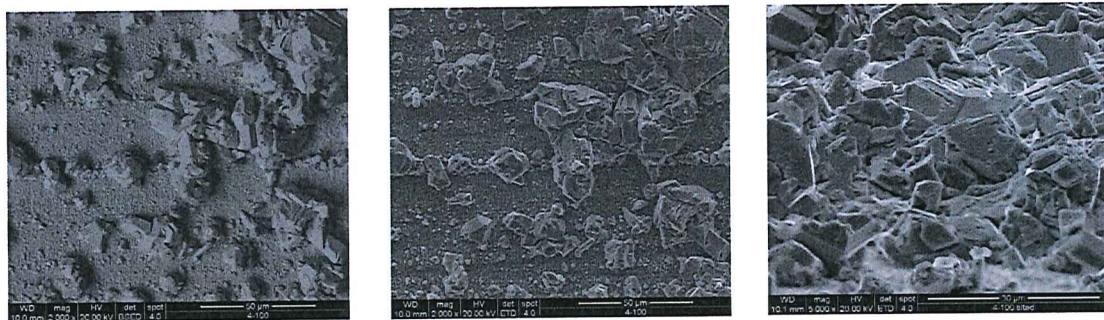
Fig. 1.52. Immagini FEG-ESEM della superficie della lamina d'Ag modello dopo il trattamento di solforazione, in cui si osservano cristalli di neoformazione.
