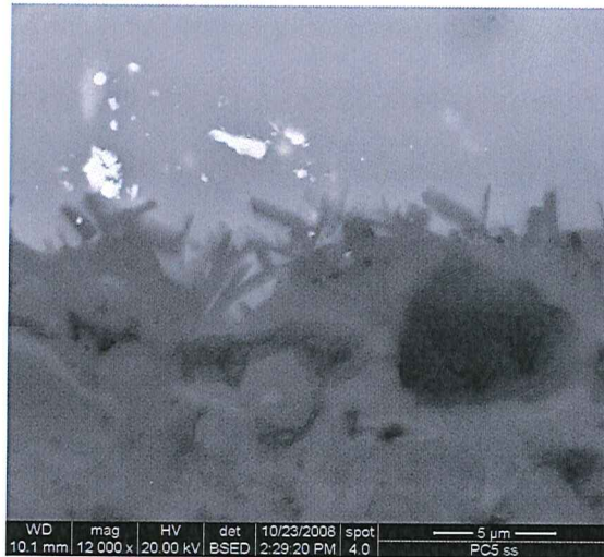
Fig. 1.57. Immagine FEG-ESEM in cui si osserva la presenza di uno strato discontinuo di cristalli di neoformazione che si sviluppano dal corpo ceramico verso la vetrina superficiale con dimensioni comprese tra 0.5 \mu\text{m} e 2.5 \mu\text{m} .
