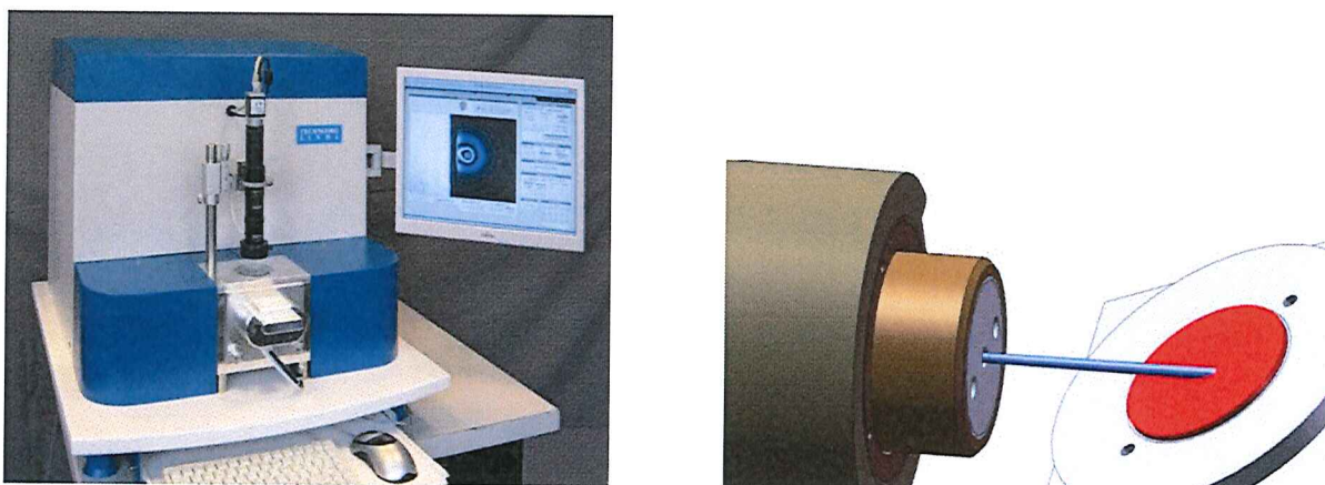
Fig. 1.64. Sistema Ion Milling SC-1000 SEM della ditta Technoorg.
