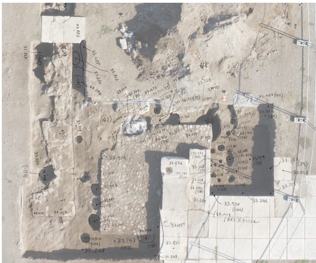
Figura 2. Esempio di applicazione del LiDAR per la documentazione di scavo presso il Capitolium di Pompei (elaborazione Politecnico di Bari)
