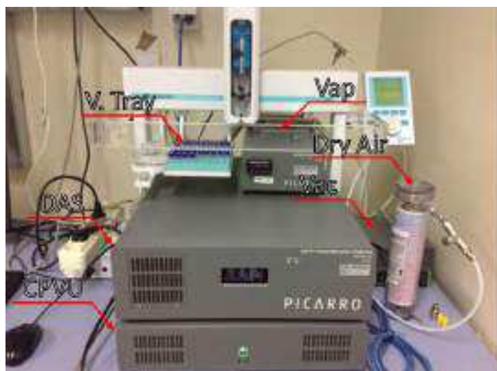
Figura 3.3: L'analizzatore L1102-i della Picarro nel laboratorio di Geochimica Isotopica. Le frecce indicano le varie componenti dello strumento riportate nel testo.
