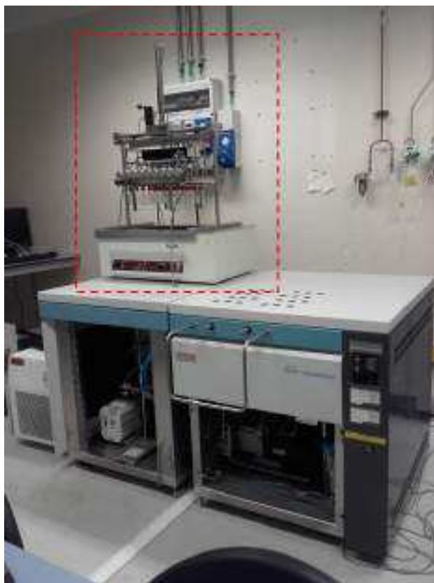
Figura 3.6: Spettrometro di massa Delta Plus Advantage della Thermo-Fisher (unità a destra) accoppiato ad HDO device (unità a sinistra) nel laboratorio di Geochimica Isotopica. Il riquadro tratteggiato evidenzia l'unità di equilibratura con bagno termostato.
