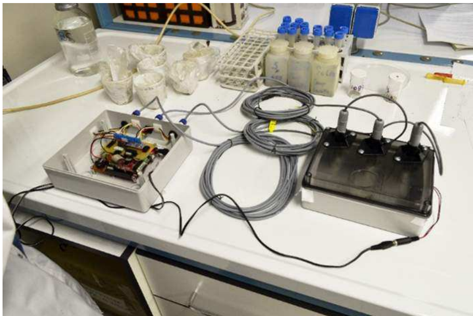
Figura 6.3: Calibrazione dell'unità MRHL. Sulla sinistra si può vedere l'unità di controllo parzialmente smontata. Sulla destra, le tre sonde AM2315 inserite nel volume sigillato contenente una soluzione sovrasatura di LiCl.
