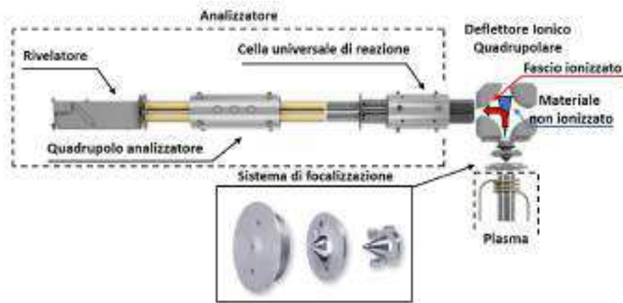
Figura 3.9: Sistema di selezione delle masse a triplo quadrupolo dello strumento Nexion 350X. Il sistema di focalizzazione a tre coni è costituito da, partendo da sinistra, Sampler , Skimmer e Hyper-skimmer (modificato da PerkinElmer (2016)).
