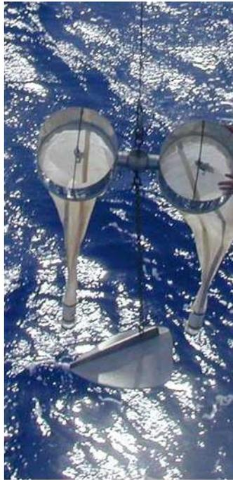
**Fig. III.4.** Il retino Bongo 40 usato per il campionamento ittioplanctonico.
