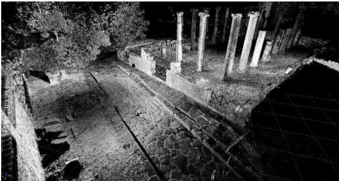
Fig. 42: basilica. Nuvola di punti di derivazione laser scanning.
