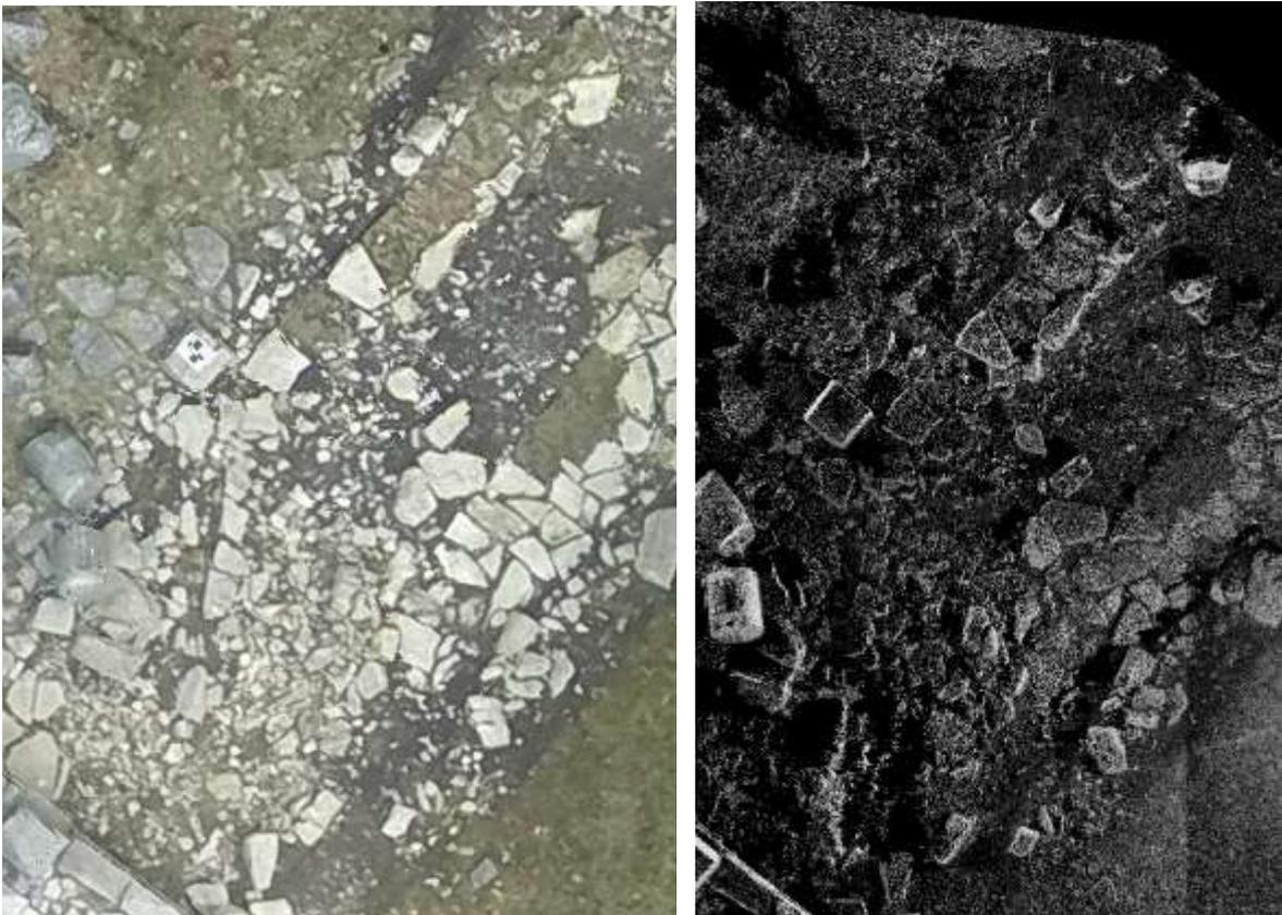
Figg. 12-13: San Pietro di Cantoni, porzione di lastricato stradale. A sinistra, ortofoto ottenuta per via fotogrammetrica; a destra, ortofoto di derivazione *laser scanning*.
