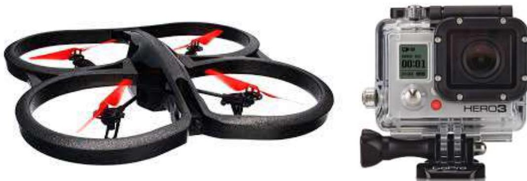
Fig. 30: il sistema di acquisizione *low cost*, composto da Parrot Ar Drone 2.0 e GoPro Hero3 Black Edition.
