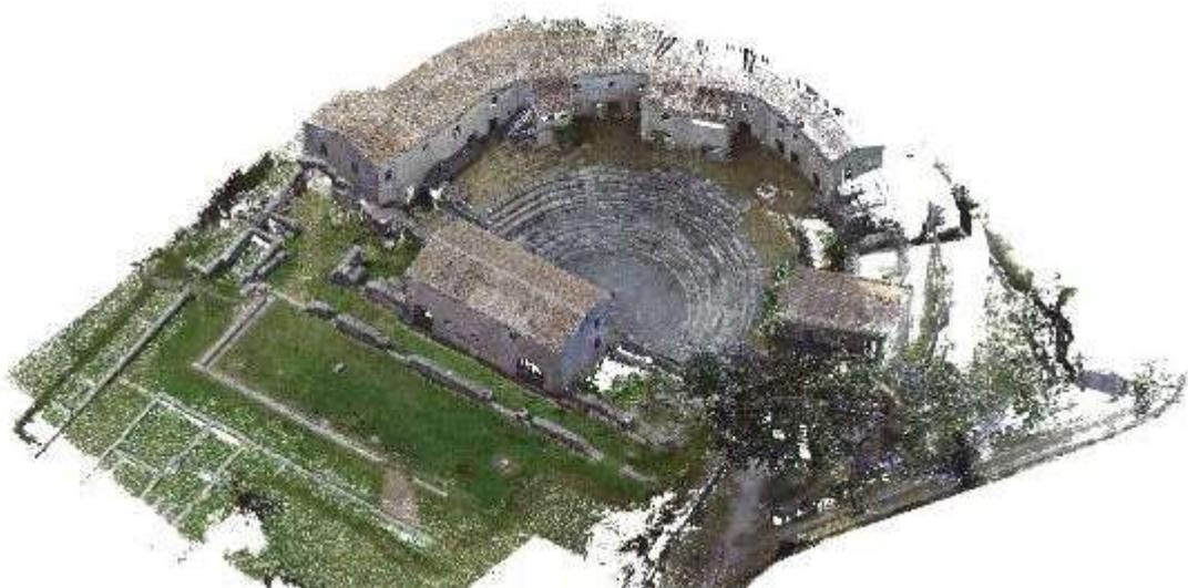
Fig. 41: teatro. Nuvola di punti di derivazione laser scanner.
