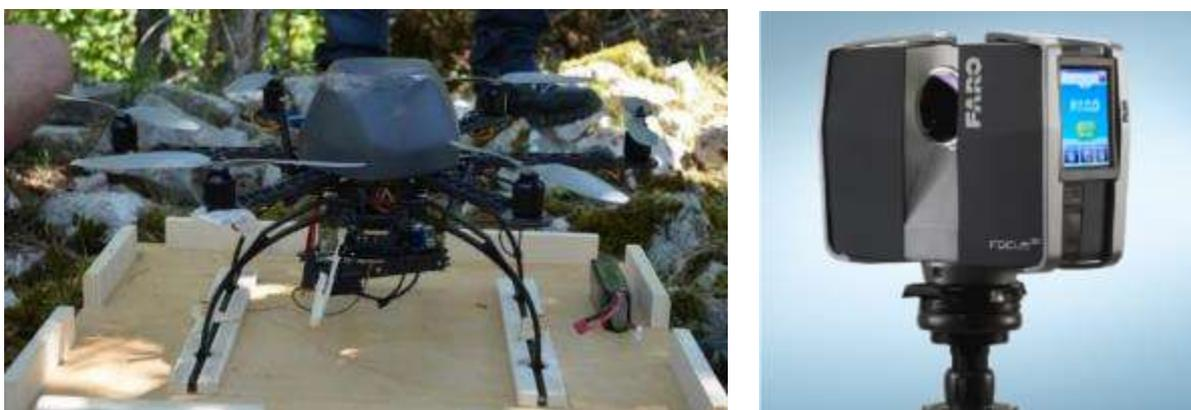
Figg. 41-42: a sinistra, l'esacottero Mikrokopter e, a destra, il *laser scanner* Faro Focus 3D.
