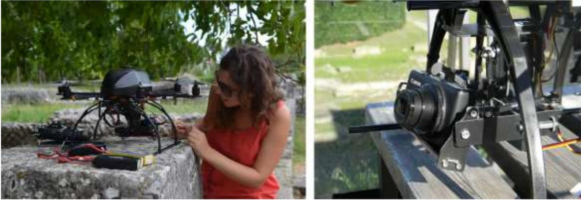
Fig. 32: il sistema di acquisizione professionale (*UAV* Mikrokopter e Canon Powershoot S100).
