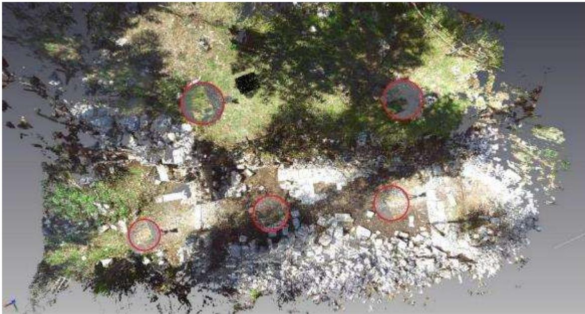
Fig. 39: chiesa di San Martino. La nuvola di punti laser e la geometria delle prese.
