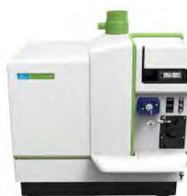
(b) ICP-MS utilizzato per determinare la concentrazione biodisponibile degli elementi (NexION™2000 B, PerkinElmer)
