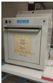
Figura 4.11 – Microonde utilizzato in questo studio della Milestone modello Ethos 1600
