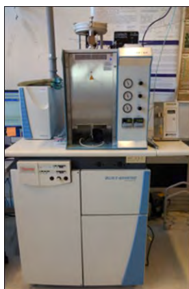
Figura 4.15 – IRMS (Delta plus XP ThermoFinnigan, Germany) e TC/EA (EA Flash 1112, ThermoFinnigan, Germany) utilizzati per determinare i rapporti isotopici di D/H e ^{18}\text{O}/^{16}\text{O} nei campioni di radicchio rosso
