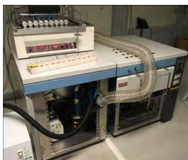
Figura 4.16 – IRMS (Delta Plus Advantage, Thermo-Fisher), accoppiato con un sistema di equilibrizzazione (HDO device), utilizzato per determinare \delta^2\text{H} e \delta^{18}\text{O} nei campioni di acqua
