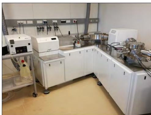
Figura 4.19 – MC-ICP-MS ( Nu Plasma HR, Nu Instruments, UK) utilizzato per determinare il rapporto isotopico di ^{87}\text{Sr}/^{86}\text{Sr}
