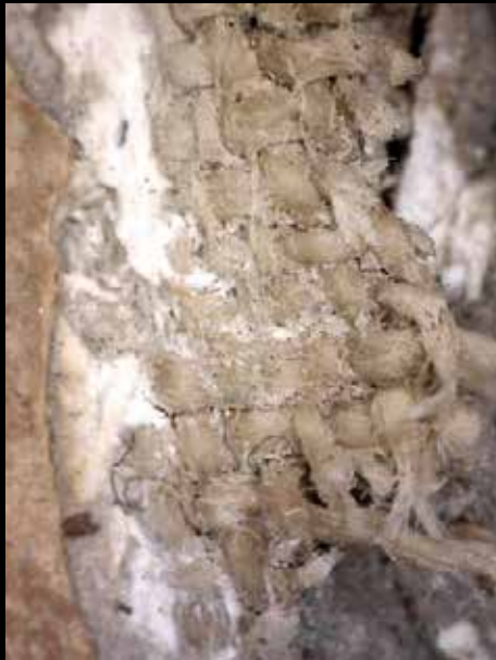
Osservazione al microscopio ottico digitale (Vis-UV, 50x) particolare della tela di impannatura visibile in corrispondenza della frattura radiale del ceppo ligneo (lato destro del torso del Cristo).
