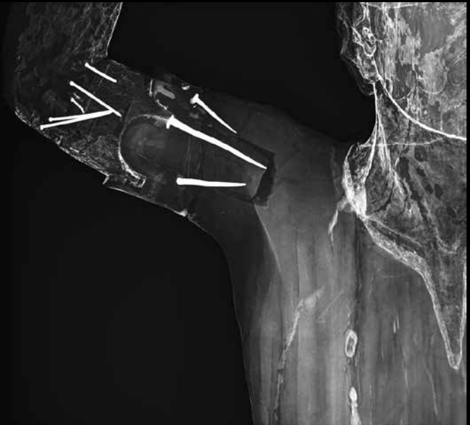
Flagellante: immagine radiografica (proiezione antero-posteriore) In questa area è chiaramente leggibile l'andamento della fibratura del legno in corrispondenza della veste. Sono visibili le zone disomogenee di maggiore radiopacità correlabili a stuccature o maggiore spessore dello strato di preparazione applicate in corrispondenza di difetti del ceppo utilizzato (fenditure, nodi, etc.). All'altezza della spalla si osservano chiaramente i tre chiodi che fissano il tenone alla mortasa, e chiodi più piccoli (recenti) che sono stati inseriti per ancorare braccio e avambraccio.
