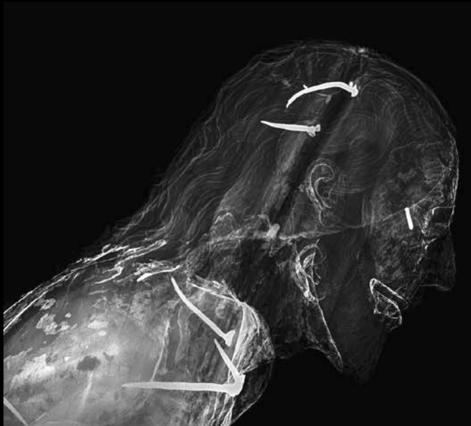
Cristo alla colonna: immagine radiografica (proiezione latero-laterale), effettuata in situ tramite sistema radiografico portatile di tipo digitale diretto. Si osservano i chiodi applicati, probabilmente, per assemblare la porzione frontale del volto al tronco principale. La maggiore radiopacità delle stesure a incarnato ne individua le superficie su cui è applicato e le estese lacune che interessano sia lo strato di colore che quello di preparazione
