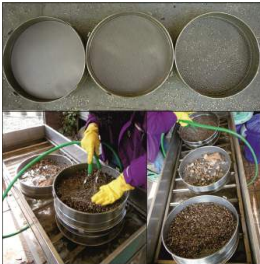
Fig. 17. I tre setacci (in alto) e le operazioni di setacciatura tramite lavaggi con acqua corrente (in basso).
