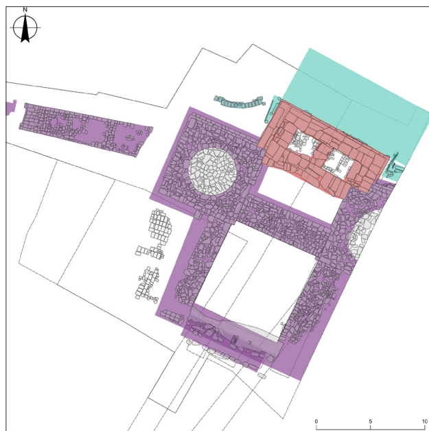
Fig. 5. Planimetria dell'area della porta-approdo. In viola: la struttura monumentale; in rosso: la spalla del ponte annesso in una seconda fase; in blu: il canale e le sue strutture (elaborazione E. Delpozzo).
