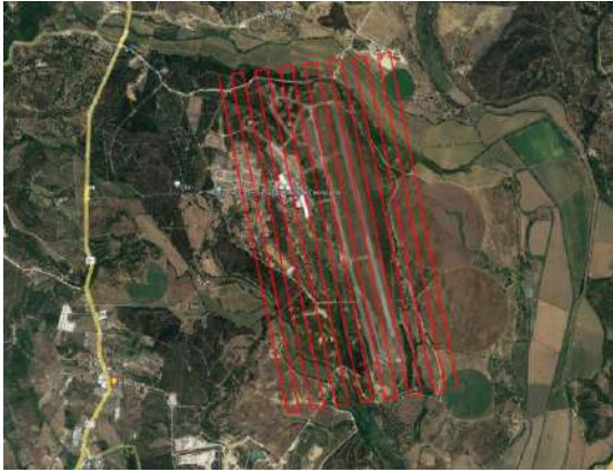
Figura 5 – Plano de voo visto de cima, com identificação dos corredores executados pelo UAV.
