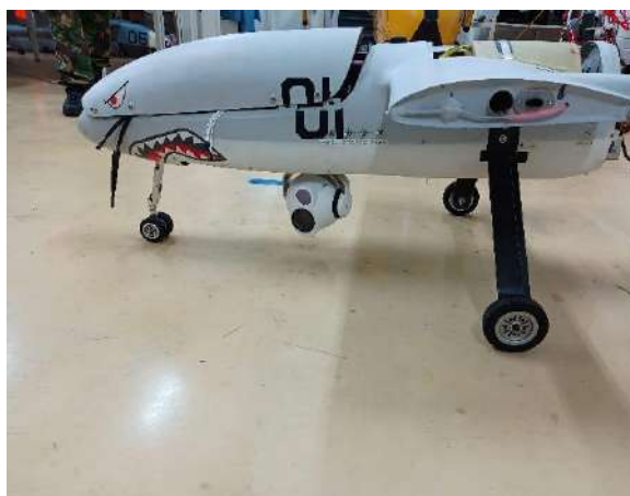
Figura 3 – UAV Alfa Extended equipada com sensor ótico do espectro visível e infravermelhos.
