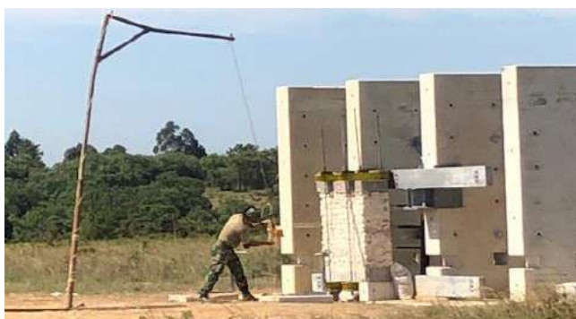
Figura 9 - Avaliação do comportamento das paredes de alvenaria de pedra tradicional face à explosão
