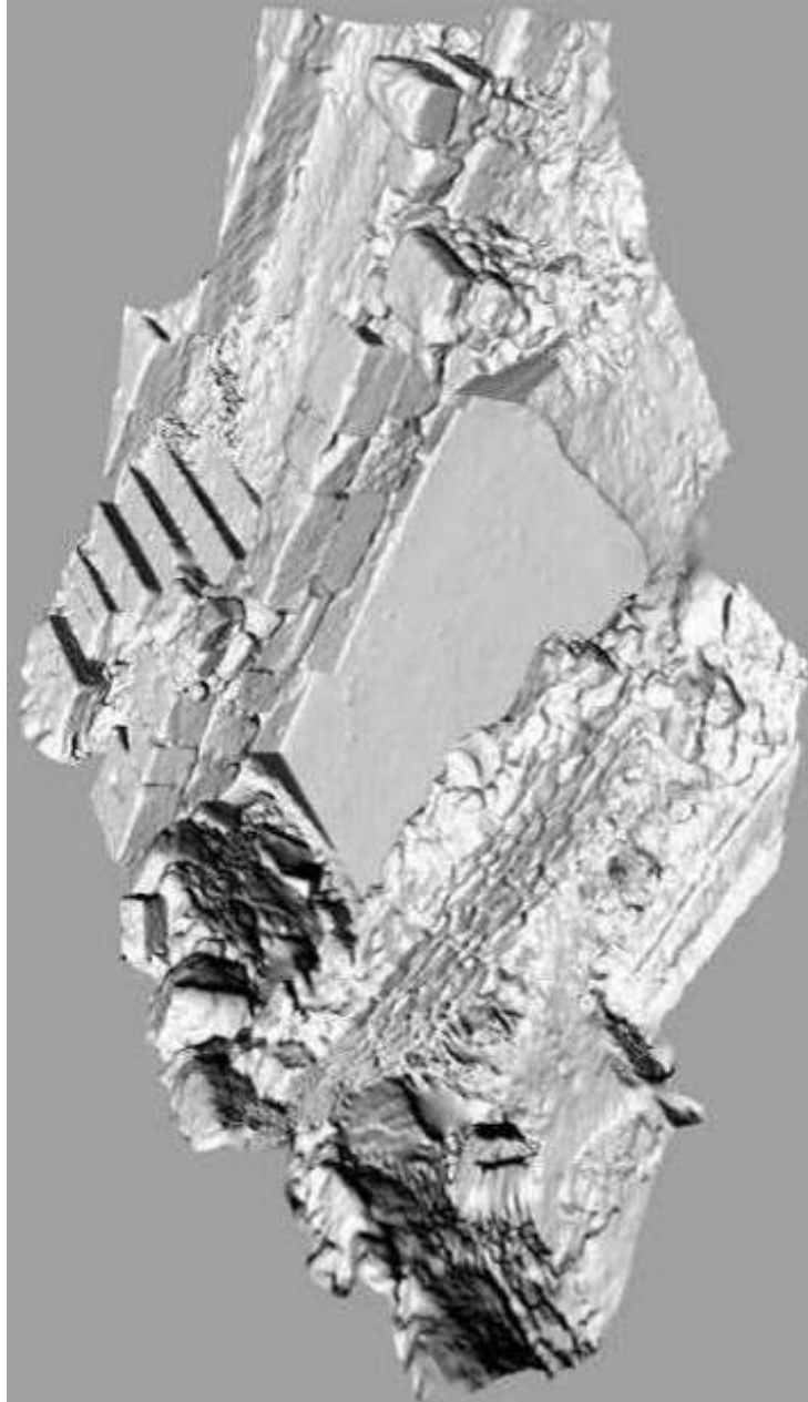
Fig. 285. Costruzione della mesh mediante il filtro Surface Reconstruction Poisson del software Meshlab (elaborazione M. Silani).
