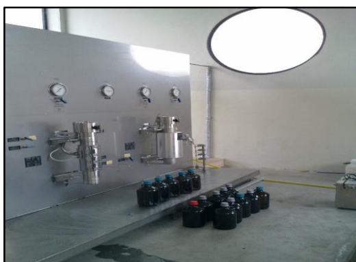
Fig.35 Raccolta campioni di fluido dopo trattamento SCWO
