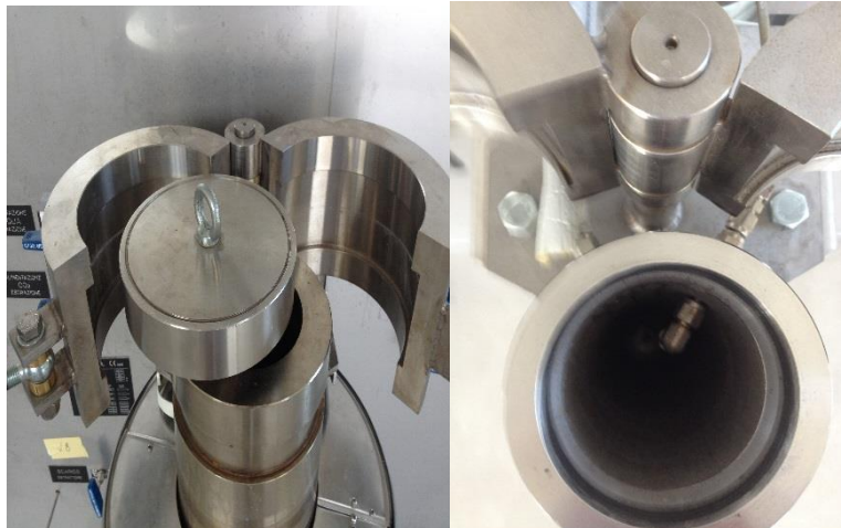
Fig. 25 Particolari del sistema di chiusura e dell'interno del reattore SFE – CO 2
