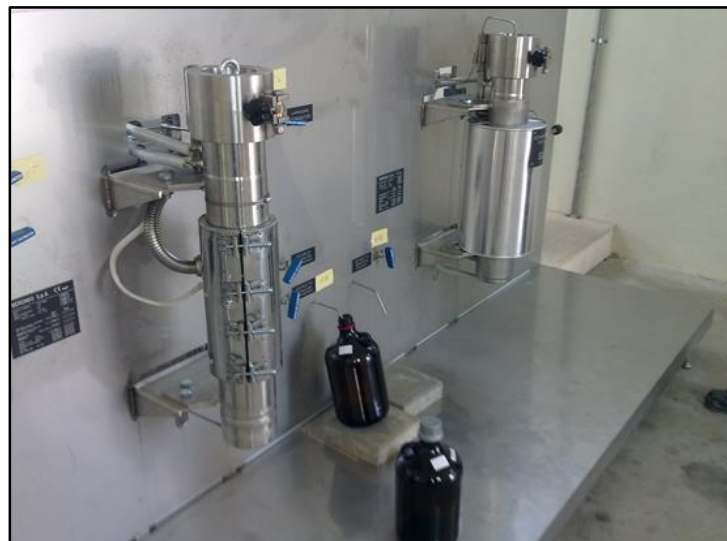
Fig.33b. Spillamento dell'estratto SFE da separatore ciclonico S1
