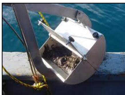
Fig. 31. Recupero di sedimento contaminato da area Canale dei Petroli – Porto Marghera
