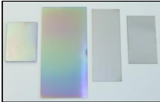
Fig. 45a. Piastrine piane in acciaio AISI 304 con trattamento PVD - Ti-MoS2
