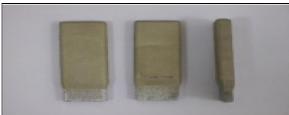
Fig.48. Lastrine in acciaio AISI 304 con coating Cold Spray Ni – Al 50% -50%, 90%-10% e 95%-5%
