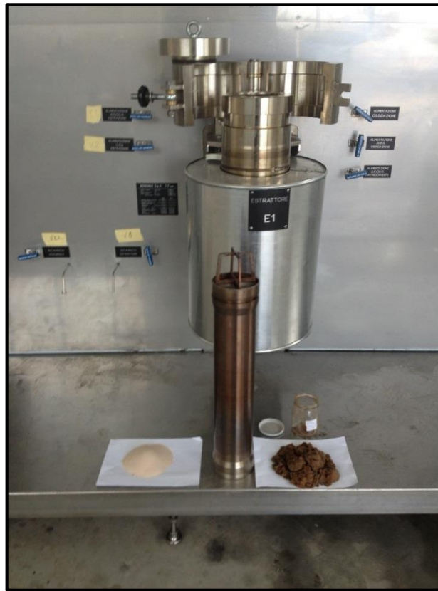
Fig. 33a. Reattore estrazione SFE con campionature di sedimenti
