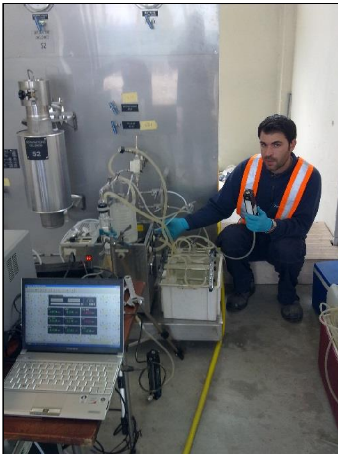
Fig. 38. Sistema di campionamento e analisi GC – MS dei gas in uscita da reattore SCWO
