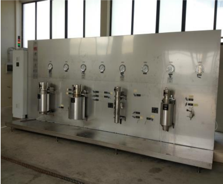
Fig. 30. Immagine anteriore e posteriore dell'impianto integrato SFE – SCWO
