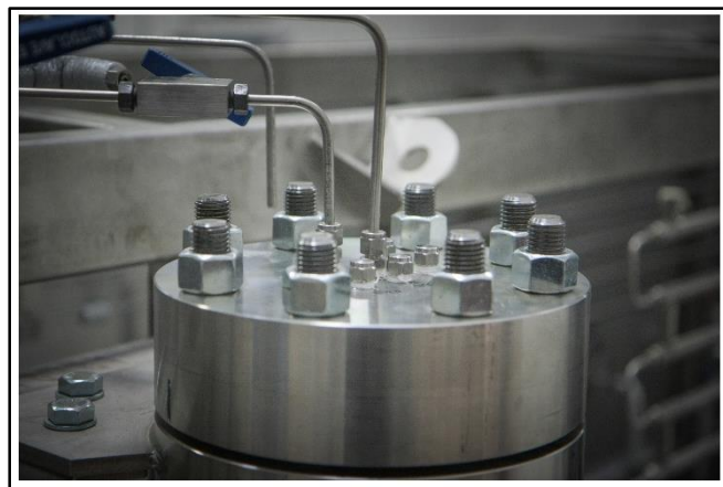
Fig. 29. Particolare della parte superiore del reattore SCWO con in evidenza i condotti per la fuoriuscita dell'acqua di processo e di raffreddamento
