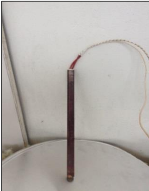
Fig.40. Corrosione di tipo diffuso in termocoppie con involucro AISI304
