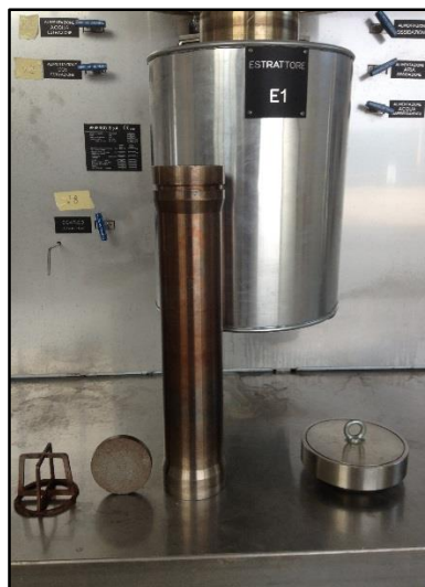
Fig. 24. Estrattore SFE con dispositivi di caricamento della fase solida e coperchio superiore di chiusura
