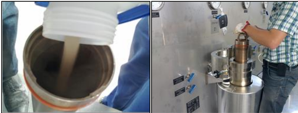
Fig.26 Caricamento del cestello ed inserimento nel reattore SFE
