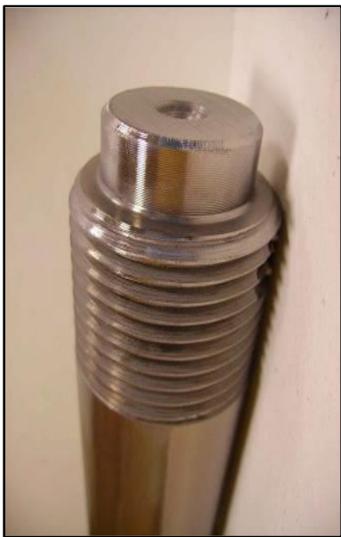
Fig. 41. Supporti interni del reattore SCWO – dettaglio - prima (sx) e dopo (dx) del contatto con acqua supercritica
