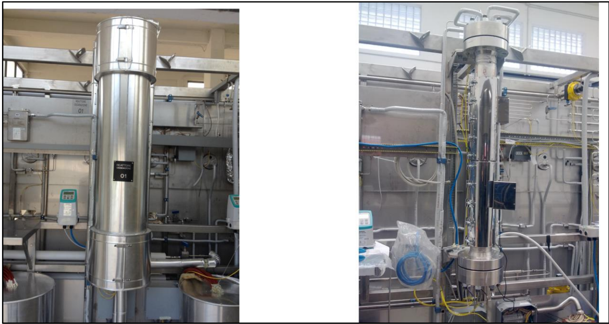
Fig.28. Reattore SCWO con (sx) e senza coibentazione esterna (dx)
