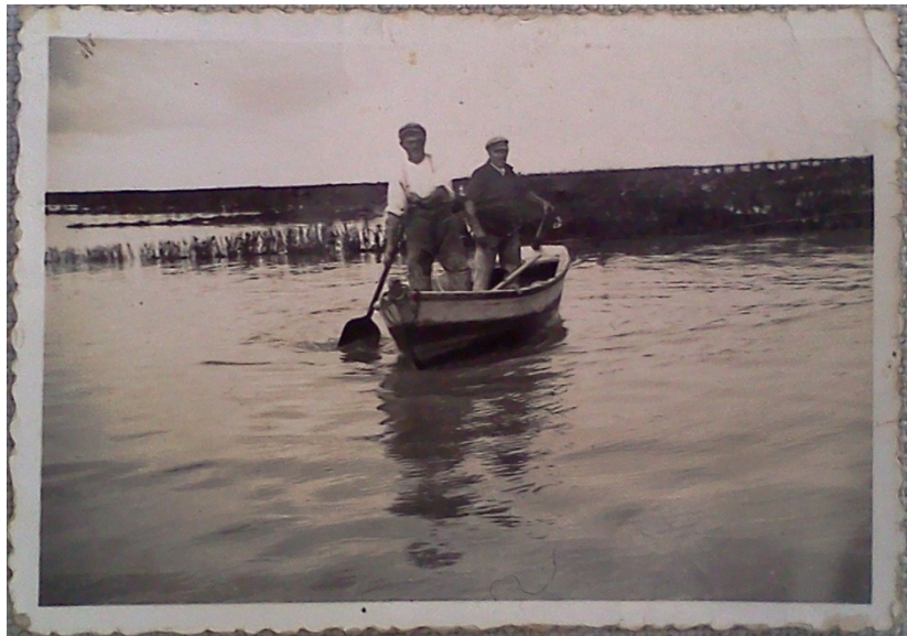
Figure 6. La technique de propulsion caractéristique avec la pale de travail utilisée à la place de l'aviron
