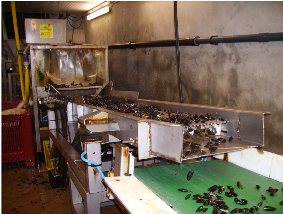
Figure 26. Un des derniers passages de nettoyage mécanisé des moules
