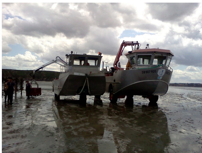
Figure 28. Deux amphibies avec leurs grues au travail sur les bouchots
