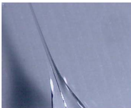
Fig. 3.1. Immagine al microscopio ottico di un microelettrodo.
