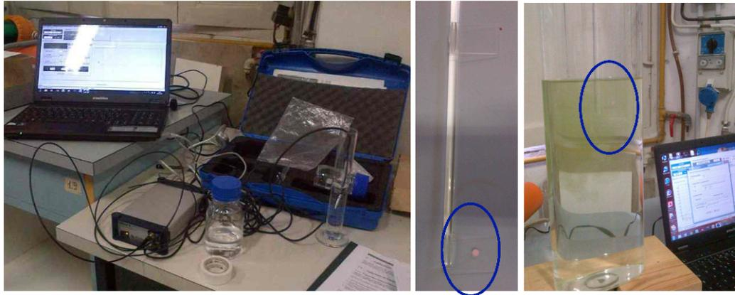
Figura 1: Il particolare dell'esperimento di messa a punto del protocollo operativo di impiego dell'ossimetro in fibra ottica Presens Fibox 3 Fiber-Optic Oxygen meter. E' stato cerchiato il particolare dell'asta di vetro che si aggancia sul profilo interno del fbr, costruita dalle officine Steroglass di Perugia su cui è stato sistemato il sensore dell'ossigeno.
