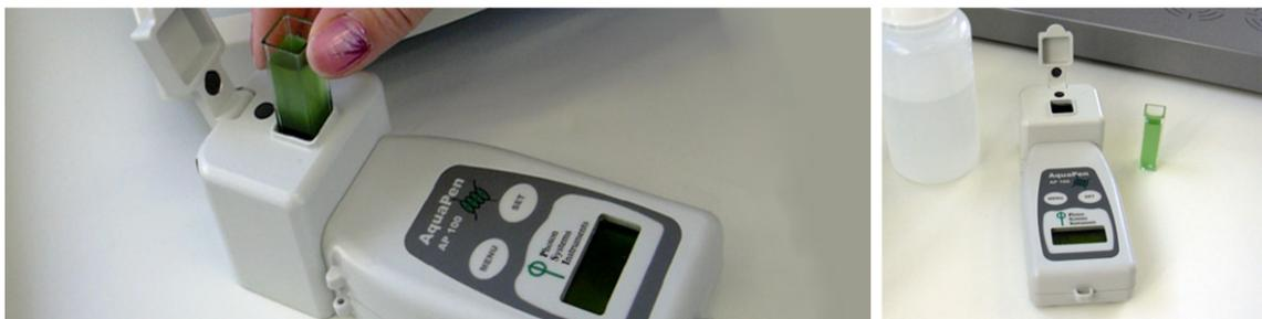
Figura 19: Il fluorimetro portatile AquaPen AP 100. E' possibile osservare l'estrema semplicità di impiego con le cuvette di plastica trasparenti (da 4 mL) in dotazione allo strumento. I tempi di attesa nelle misure dipendono dal protocollo impiegato e vanno da un tempo minimo pari a 40 secondi a circa 7 minuti.
