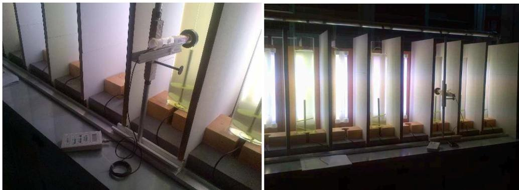
Figura 4: Il particolare del sistema di ritenzione della sonda Licor, scorrevole su binario che ha permesso di effettuare rapidamente misure a due diverse altezze sul banco sperimentale dei 9 fbr stimolati acusticamente e sulla linea dei 3 fbr di controllo collocata sul lato opposto.
