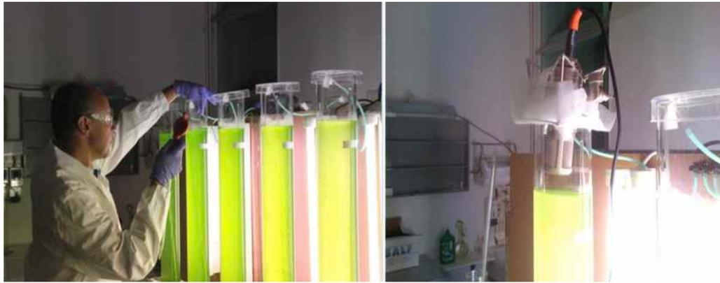
Figura 39: Particolare dei prelievi di biomassa sui fbr e delle misure di acustica (immagine di destra) con il microfono a condensatori nello strato di aria appena sopra il pelo libero delle colture nei fbr.
