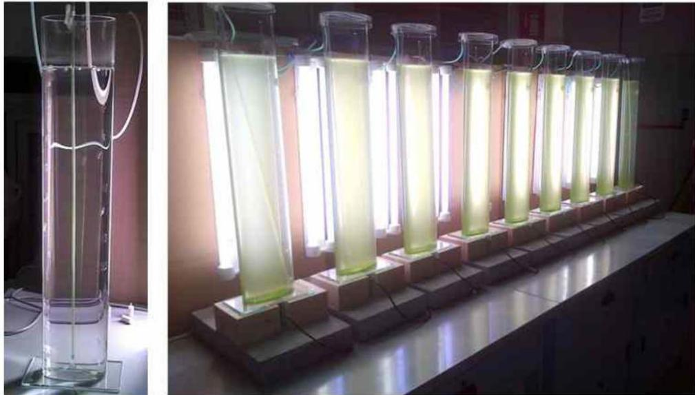
Figura 21: A sinistra il particolare del sistema di rilascio delle bolle d'aria e a destra un'immagine del bando sperimentale con i 9 fbr provvisti di attuatore acustico alla base.
