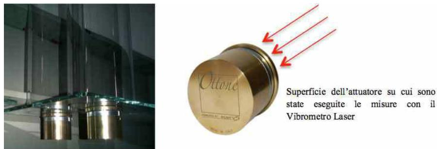
Figura 82: Il particolare dell'ancoraggio dell'attuatore acustico Ottone sulla base del fotobioreattore, con un disco biadesivo della 3M. A destra, è indicata la superficie vibrante oggetto delle analisi LDV.
