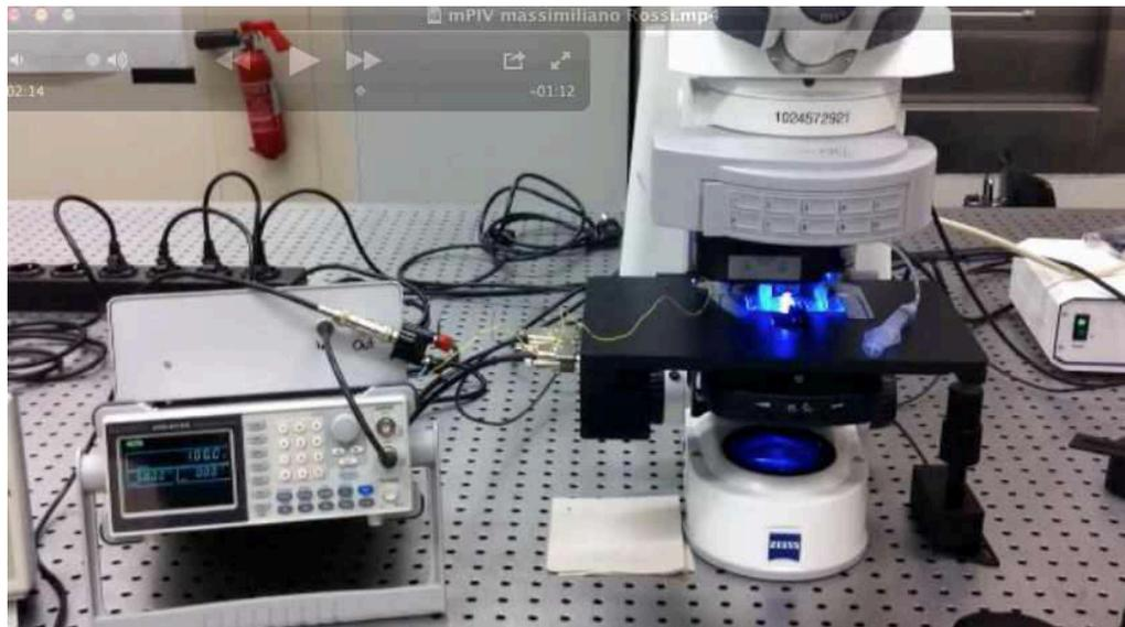
Figura 42: Sul banco per la sperimentazione mPIV, partendo da sinistra si osservano il generatore dei segnali acustici, il dispositivo piezoelettrico impiegato per la riproduzione dei segnali acustici, il micro canale posizionato sul vetrino copri oggetto del microscopio invertito Zeiss.
