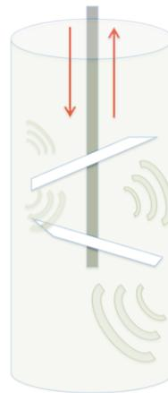
Figura 47: Particolare dei moti e vortici rotazionali che si osservano nel fbr durante il moto alternativo dell'agitatore lungo la colonna del fbr.
