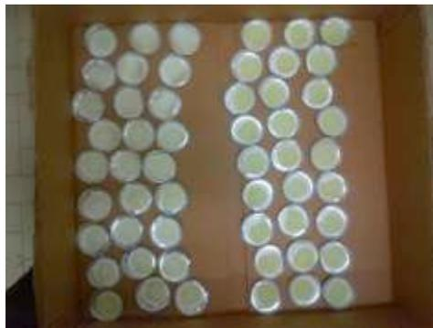
Figura 5: Il particolare dei piattini di alluminio su cui sono stati riposti i filtri contenenti la biomassa da essiccare.
