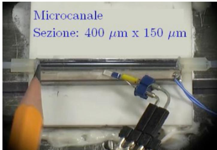
Figura 44: Il particolare del microcanale e del dispositivo piezoelettrico impiegato per la riproduzione dei segnali acustici dalle dimensioni davvero ridotte come si osserva in raffronto alla punta della matitanella foto a sinistra.
