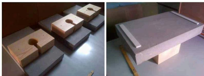
Figura 19: Le basi in marmo e la culla in legno per alloggiare l'attuatore acustico e il fbr. A destra il particolare del biadesivo d'isolamento delle basi in marmo dal piano di appoggio.
