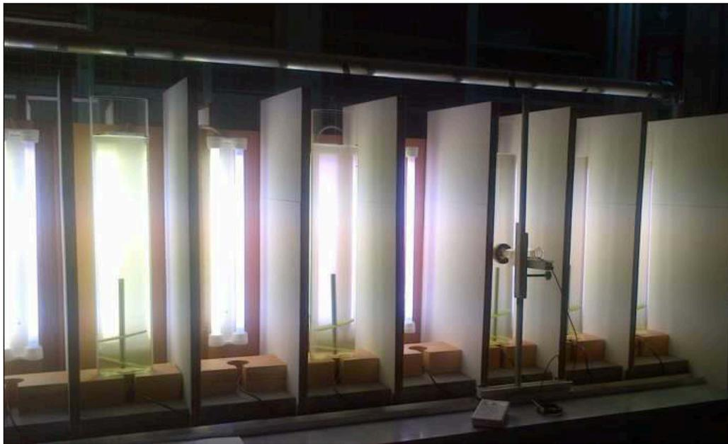
Figura 60: Il particolare della misura con la sonda Li-Cor e il binario su cui scorre il supporto mobile necessario a posizionare il sensore nelle due posizioni Alto – Basso lungo la colonna di ciascun fbr.
