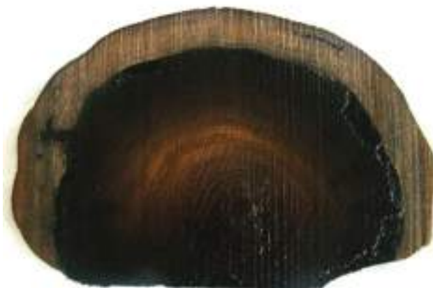
Figura 22 Semi rondella di legno di Quercus Sp. imbibito, con differenziazione di alburno e durame nonostante l'inscurimento (da BRODA HILL 2021)
