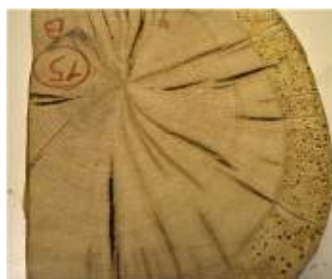
Figura 16 Rondella di trave che conserva una parte dell'albume pesantemente degradata (foto A. Lucchini 2019, presso CNR IBE)
