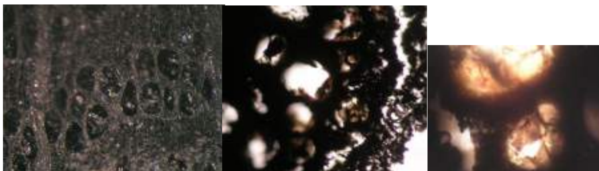
Figura 8A Sezione trasversale allo stereomicroscopio; 8B Sezione trasversale al microscopio ottico a luce trasmessa; 8C dettaglio delle tille
