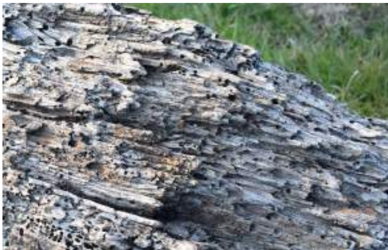
Figura 23 Dettaglio dei tunnel causati dalla Teredine (Reperto di Cavallino Tre porti (VE) (Foto A. Lucchini 2020)
