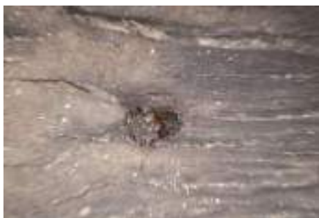
Fig.62 Foro con resti di caviglia ancora in sede, dettaglio dell'imbarcazione di Monticelli D'Ongina.
