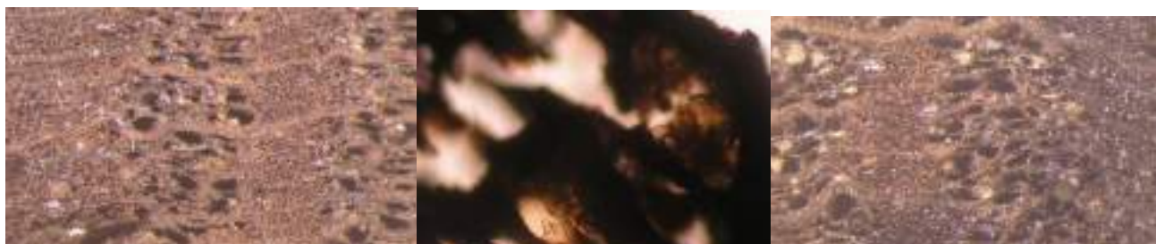
Figura 23A sezione trasversale dello scafo allo stereomicroscopio; 23 B dettaglio di una tilla nella sezione sottile; 23C sezione trasversale (Sir1_585_c2)
