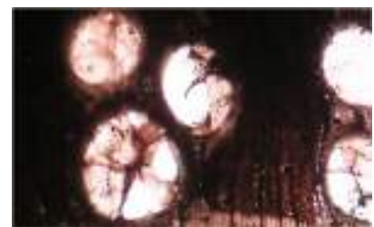
Figura 18 A Rappresentazione di tille in GIORDANO 1981; B Tille al microscopio nei vasi dell’anello poroso di Quercus sp. (Foto A. Lucchini 2019)
