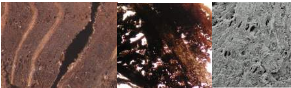
Figura 4A Sezione trasversale allo stereomicroscopio (Piz2_628_C4); 4B Sezione trasversale al microscopio ottico (Piz2_628_C4); 4C Immagine al SEM (Piz2_628_C1)
