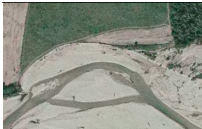
Figura 19: immagine satellitare del tratto del fiume Piave che lambisce le sponde del quagliodromo realizzato nel comune di Belluno (tratto PIA011). Sono evidenti i rilevanti fenomeni erosivi che interessano la sponda destra.
