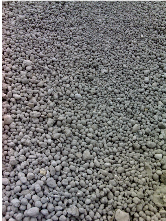
Fig. 3.13: Esempio di terreno nella sua forma finale ottenuta con la tecnologia HPSS denominato Newlystone
