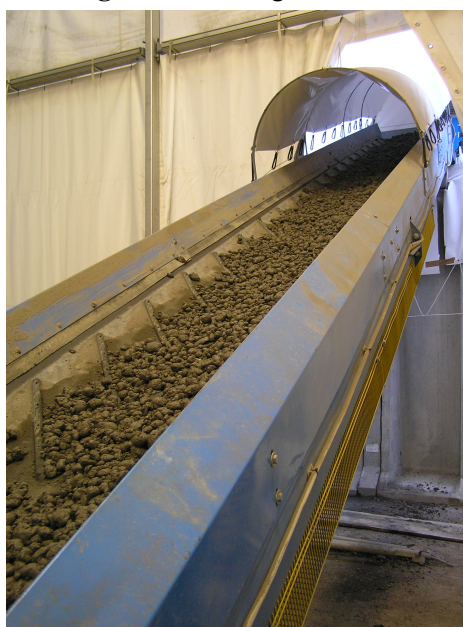
Fig. 3.17: Tramoggia che porta i granuli allo stoccaggio dedicato alla maturazione
