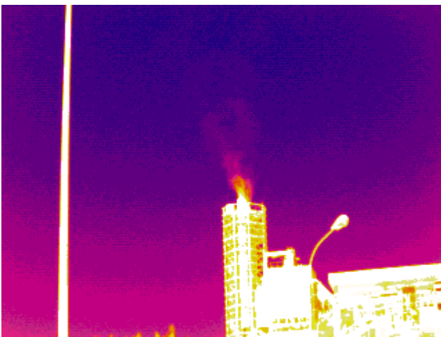
Figura 3.8 Immagini termografiche della ciminiera di un impianto di incenerimento di rifiuti. I colori, dai più freddi ai più caldi indicano progressivamente la temperatura della zona inquadrata.
