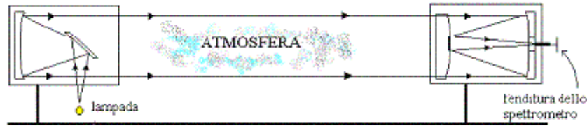
Fig. 2.1: Rappresentazione schematica della DOAS applicata alle misure orizzontali. La sorgente artificiale e il ricevitore sono posti ai due estremi della traiettoria ottica di misura, che può andare da qualche centinaio di metri fino a 10 km.
