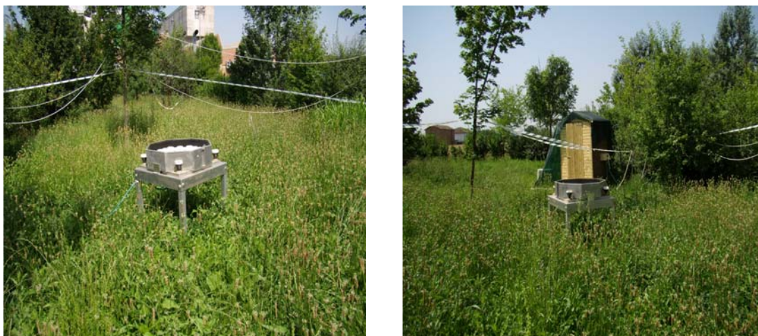
Figura 3.10 MiniSODAR (a sinistra) e alloggiamento del sistema di acquisizione (a destra)
