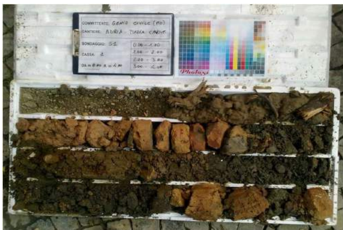
Fig.2.13. Sacchetto Perforazione Geotecnica S.r.l. Immagine relativa alla conservazione di un carotaggio effettuato nel centro urbano di Adria nell'anno 2013.
