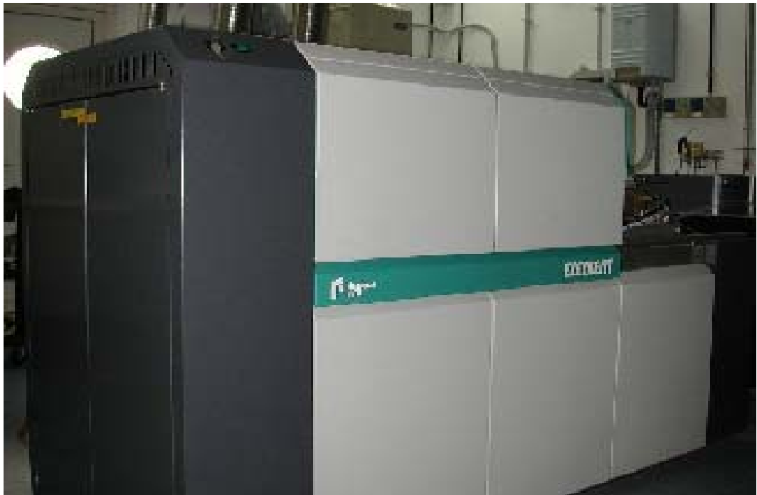
FIG 2.3. Sistema di acquisizione LA-ICP-MS, Perkin Elmer DRCE-Laser microprobe ArF 193 nm Geolas 200Q, Microlas (ICP- MS).
