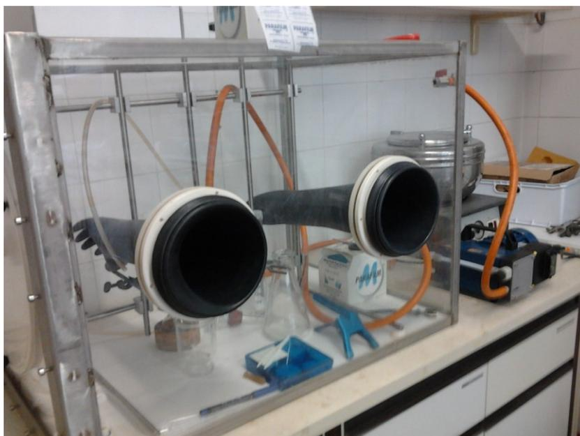
Fig 3.1: glove box utilizzato per la sintesi delle formulazioni di nZVI in atmosfera inerte.
