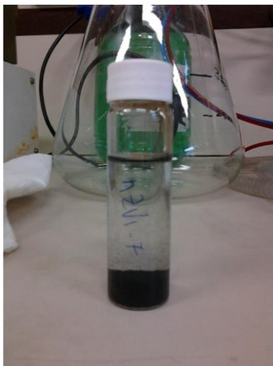
**Fig 3.2: nZVI sintetizzato e conservato in metanolo.**
