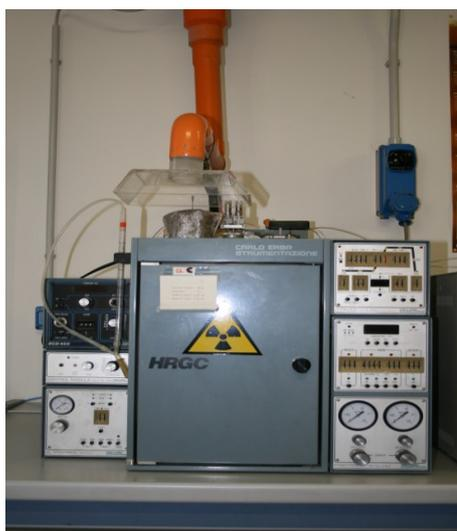
Fig. 3.5. GC/ECD utilizzato per le prove cinetiche.
