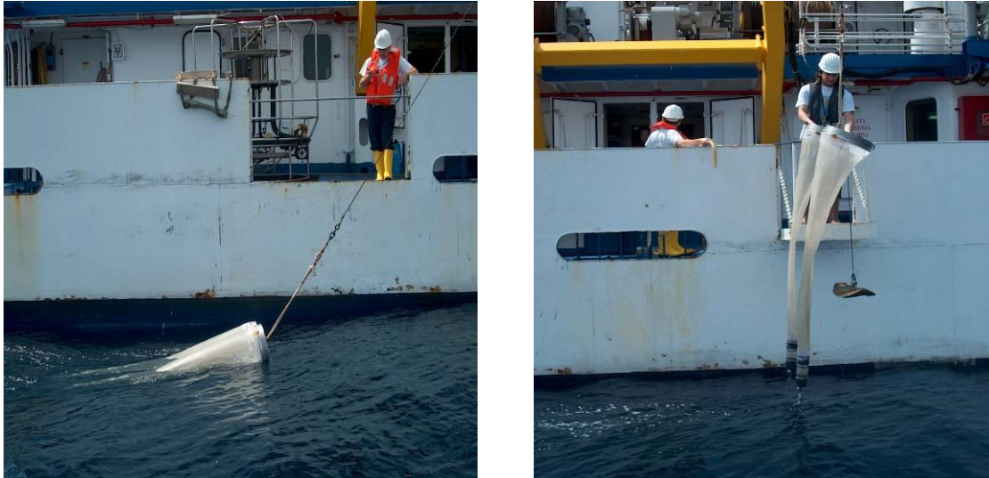
Figura II.10 a) e b): Operazioni di recupero della rete Bongo 40 a bordo della nave
