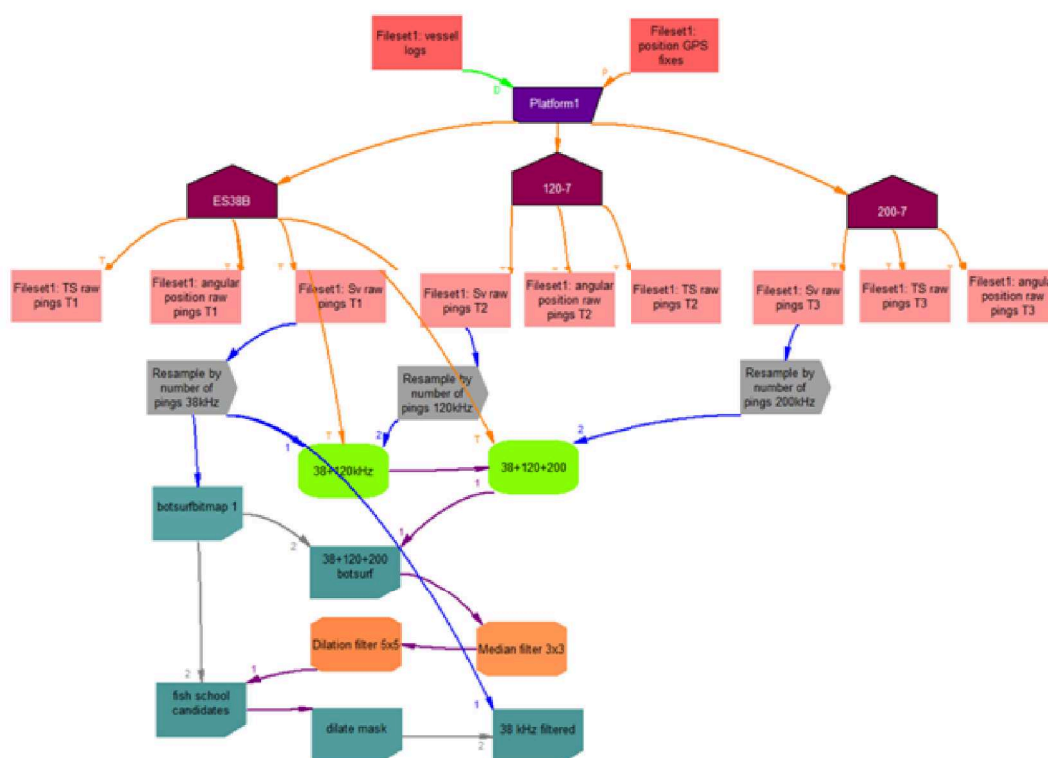
Figura 2.3: Struttura dell'algoritmo “fish school filter” creato con il modulo “Virtual Variable” del software Sonardata Echoview.
