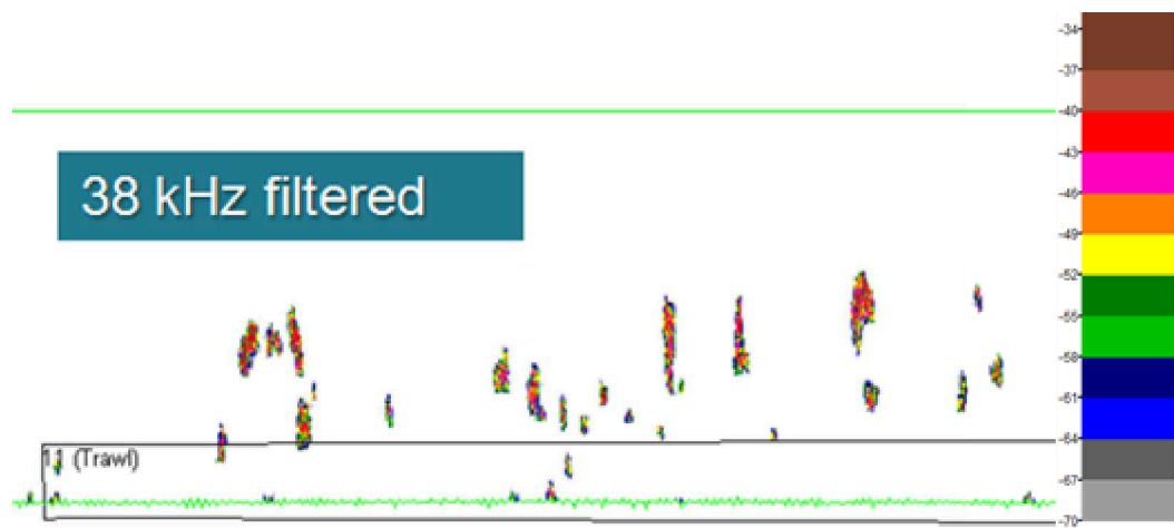
Figura 2.9: Ecogramma finale con le ecotracce isolate e soglia minima di visualizzazione di -70 dB.
